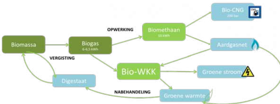
Figuur 10: De valorisatieketen voor biogas. (Bron: biogas-e)
