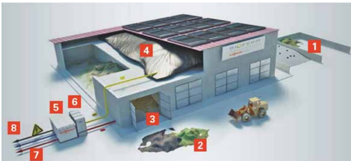
Figuur 9: schematische voorstelling van een garageboxfermenter (Bron: Nelles, 2011).
